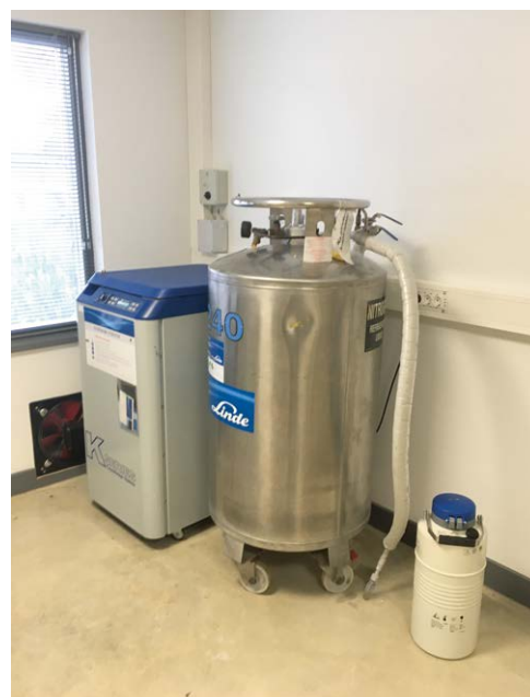
Het ingevroren sperma wordt opgeslagen in een opslagtank gevuld met vloeibare stikstof, genaamd K10 (links op de afbeelding), die automatisch wordt bijgevuld vanuit het stikstofopslagvat rechts.
